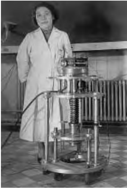
自ら考案した圧力可変・自動自記 ウィルソン霧箱とともに (1957年)
